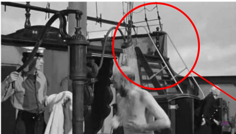
Vergleicht man den Durchmesser der Masten des Schiffs im Film mit denen der ARETHUSA II bzw. PEKING, so sind die „Filmmasten“ um ein Vielfaches dünner. Auch fehlen beim Filmschiff überall dort Nagelbänke, wo bei der PEKING massive Exemplare angebracht sind.
