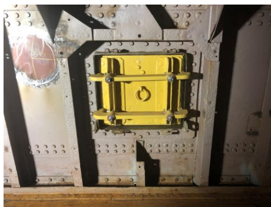
Hilfsladeluken an beiden Seiten der Bordwand zur Stau= Optimierung des Salpeters unter Deck
