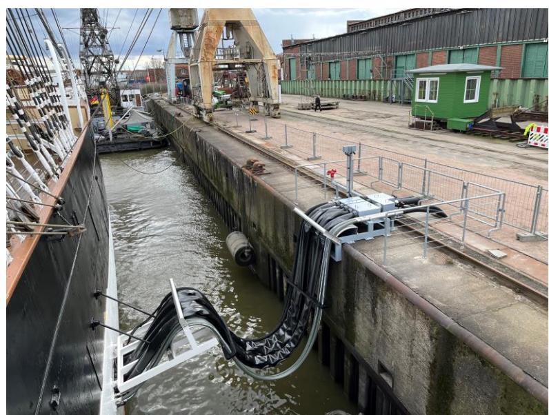
Fast zeitgleich mit der neuen Gangway hat die PEKING auch feste Elektro- und Zu- und Abwasseranschlüsse bekommen, sodass die Sanitäranlagen an Bord demnächst funktionsfähig sein werden.
