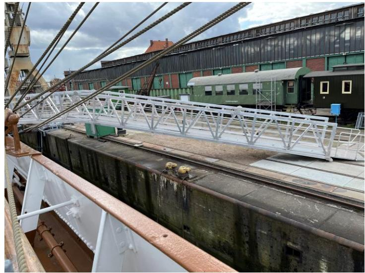
Seit dem 29.03.2023 kann man das Schiff intern über eine sehr komfortable, Barriere arme Zugangsbrücke (Gangway). Die alte Gangway dient als Notausgang von der Back
